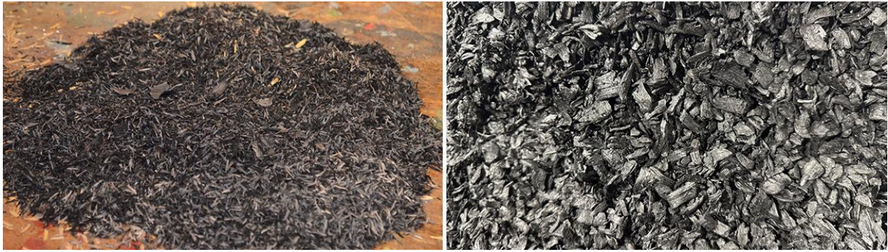
Hình 1. Vỏ trấu (trái) và phế phẩm gỗ rừng (phải) được chuyển hóa thành than sinh học bằng thiết bị khí hóa quy mô nhỏ tại một trang trại ở Colombia. Nguồn: Gustavo Roa và Jaya Nepal.
