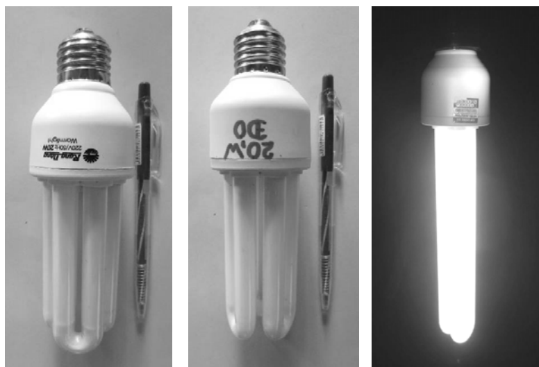
Hình 2.1. Ba loại compact được sử dụng trong thí nghiệm. (A) Bóng vàng, 3U, 20W; (B) Bóng đỏ, 3U, 20W; (C) Bóng đỏ, 2U, 20W
