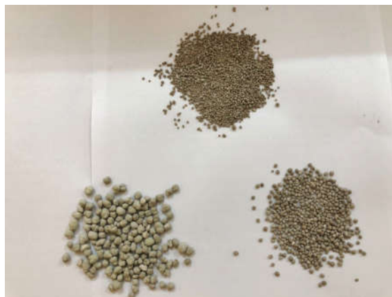
Hình 4. Hình dạng viên phân NPK-S ứng với 3 lớp bọc dinh dưỡng
